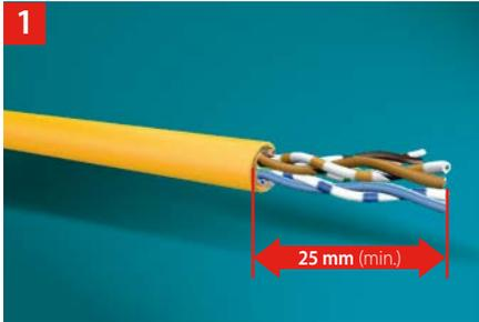
Kabelmantel auf ca. 25 mm Länge entfernen.
